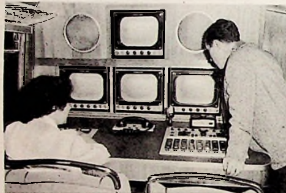
Das Regiepult des neuen Fernseh-Übertragungswagens vom Sender Freies Berlin
